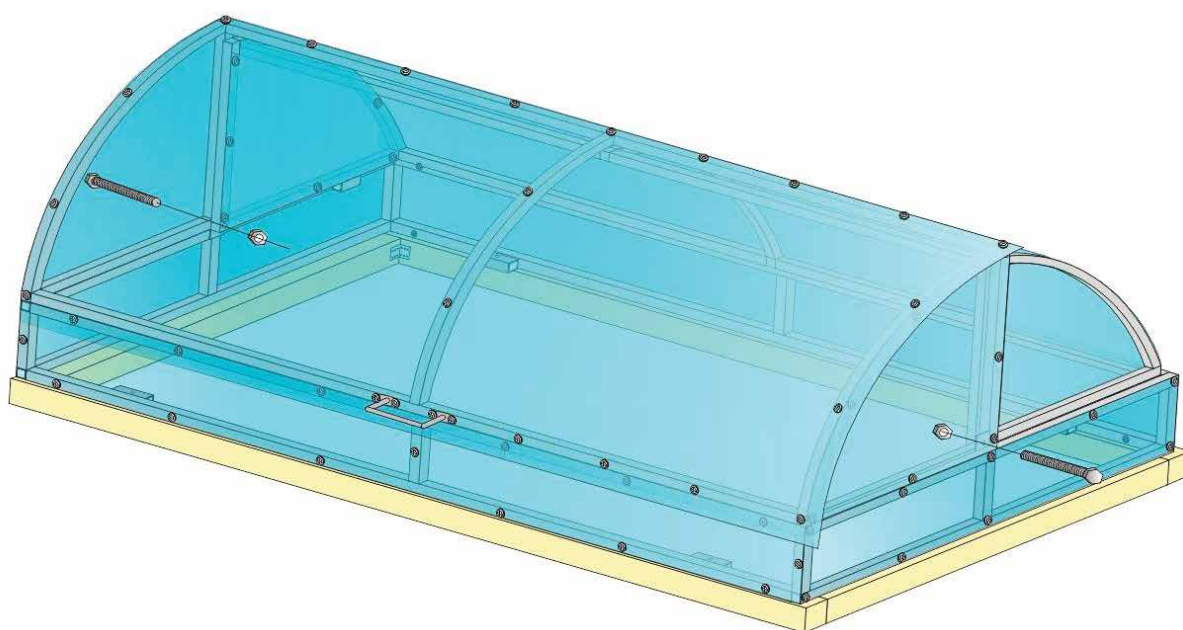
Рис №8. Соединение нижней части теплицы с малой и большой дверью осевыми винтами М6х60.
